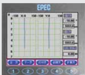
◀ 曲线页面 Curve page 抓斗偏移曲线显示 Cure display of grad offset
